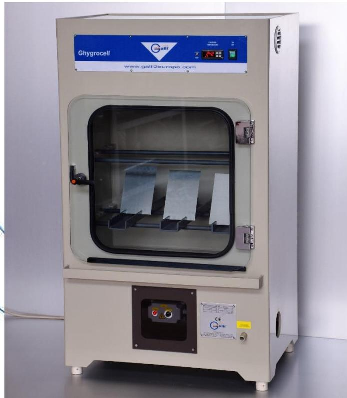
Prove di corrosione mediante l'esposizione ad ambiente saturo di umidità.
