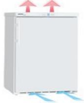
Alcune misure possono essere integrate sotto-banco. In questo caso è necessario predisporre una griglia (min. 200 cm<sup>2</sup>) sul piano di lavoro per garantire sufficiente aerazione all'apparecchiatura. In caso non fosse possibile realizzare una griglia, l'altezza della nicchia deve essere di almeno 860 mm per facilitare la dissipazione del calore.
