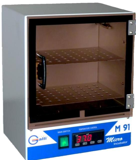
Il **Micro-Incubatore M91** è utilizzato in molteplici ambiti di laboratorio, dove si vuole avere uno strumento universale che controlli in modo delicato ed accurato la temperatura.
